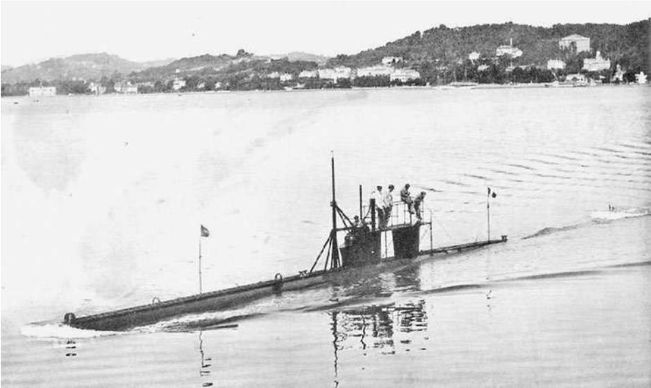
El *Gustave Zédé*, con propulsión puramente eléctrica, fue el primer submarino francés en emplear un periscopio. Durante maniobras efectuadas con la flota francesa en 1893 y 1901, demostró el potencial de este tipo de naves en la guerra naval al atacar por sorpresa a varias unidades de superficie. (foto tomada de Domville, Charles, *Submarines of the World's Navies*, Lippincott, Londres, 1911, p.137).
